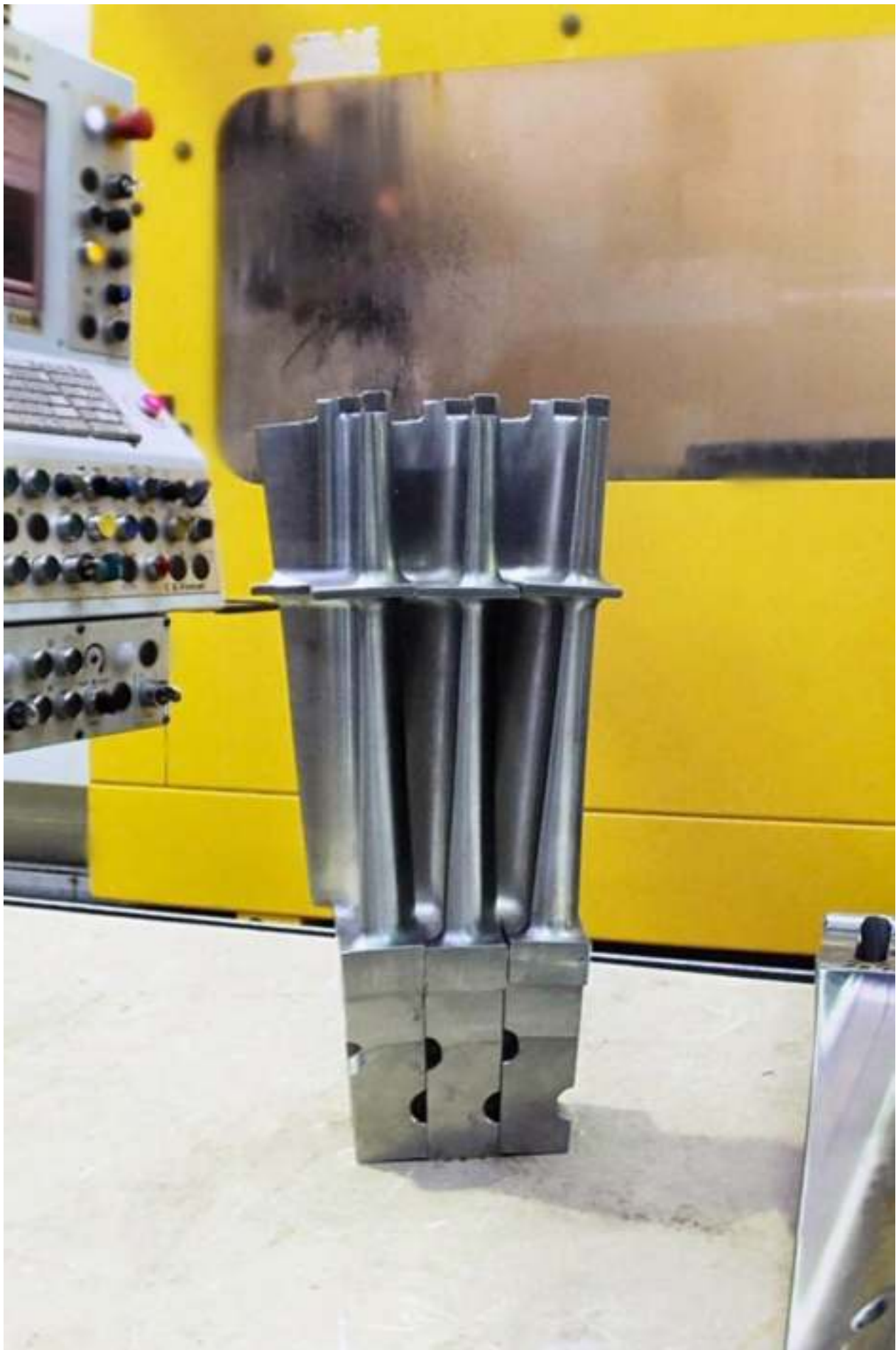
Рабочие лопатки 25 ст. Паровая турбина ПТ-60-90/13 (ЛМЗ)
