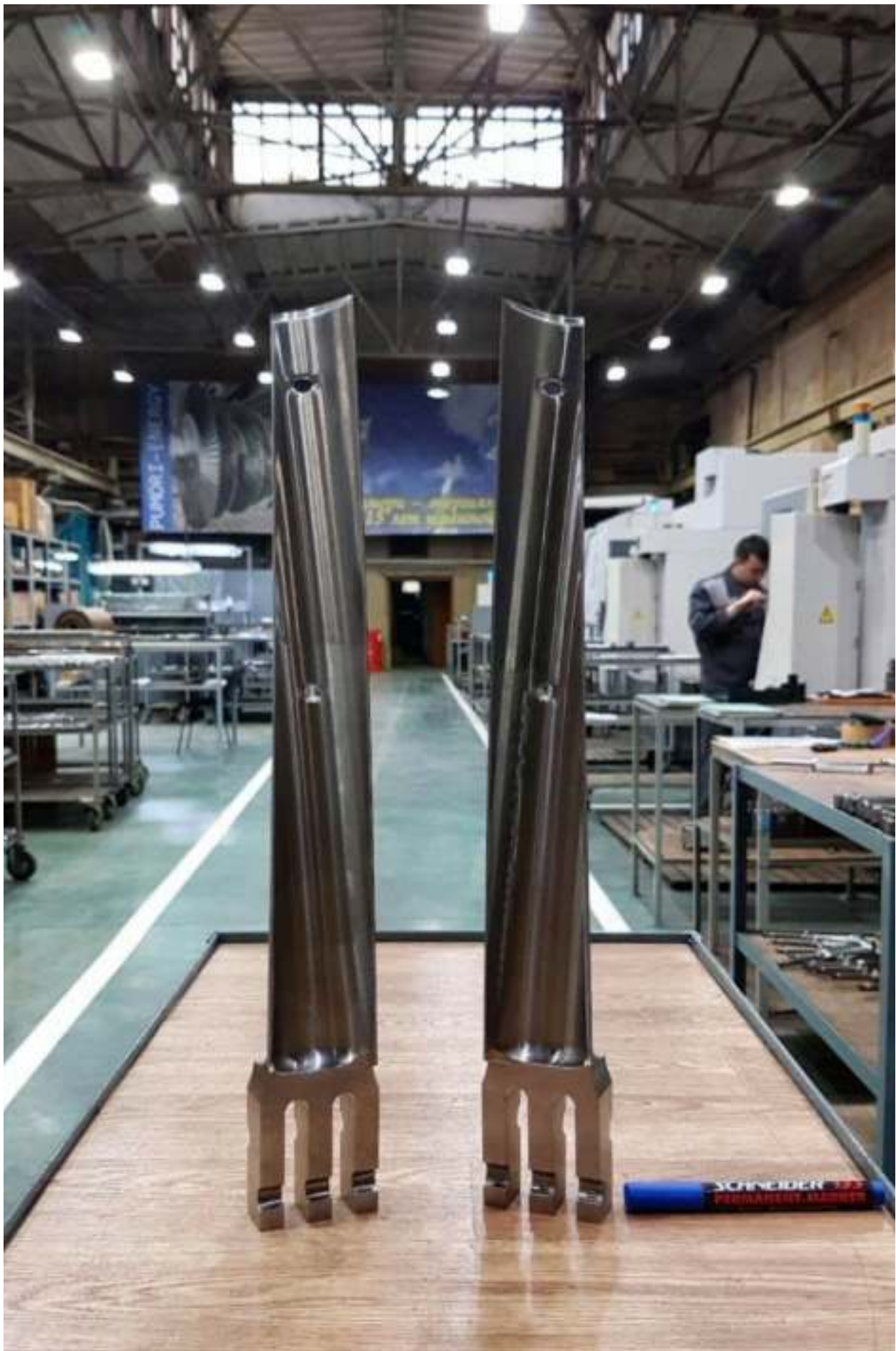
Рабочие лопатки 32 и 37 ст. турбины К-300-240 (ЛМЗ)
