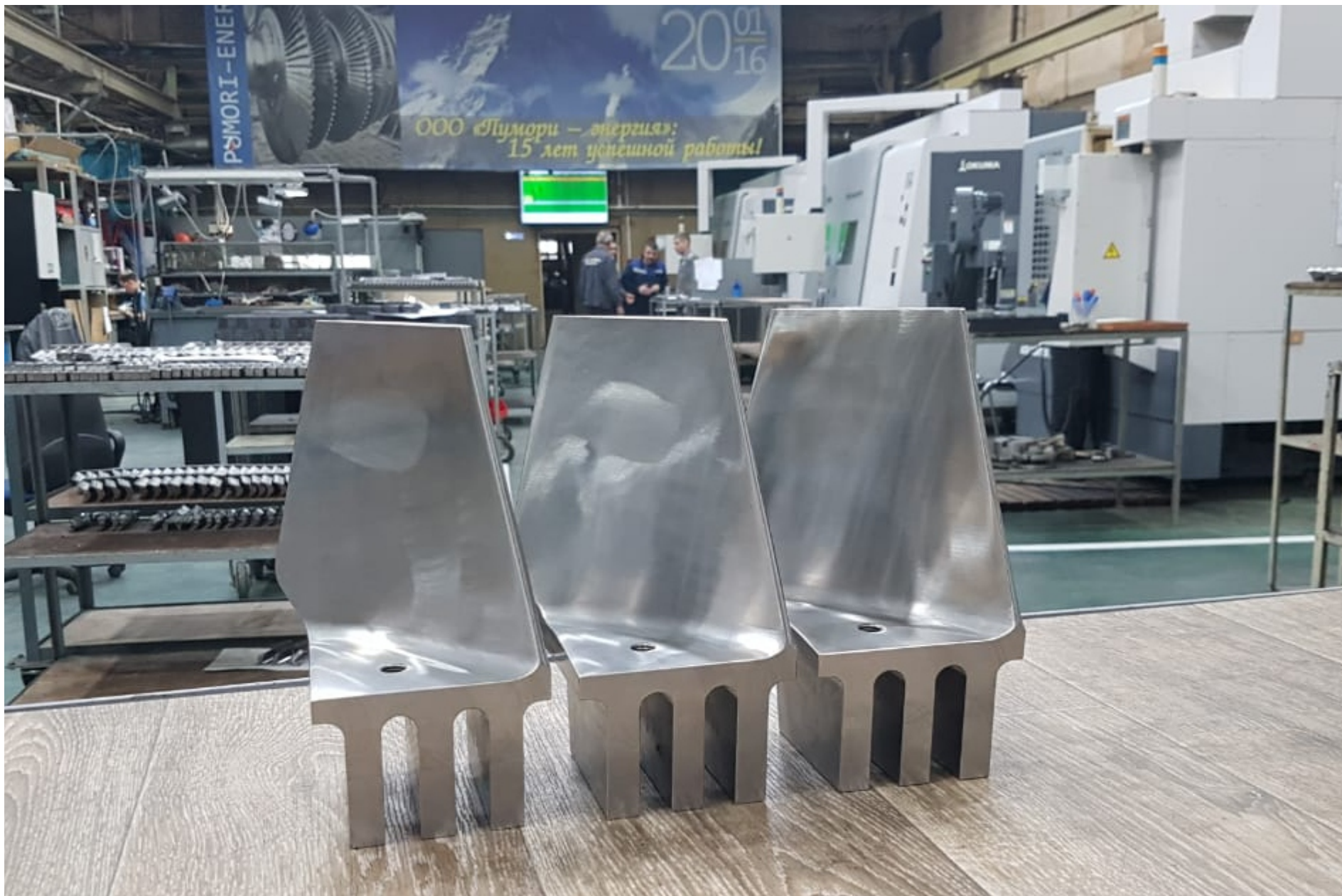
Лопатки вентилятора генератора (ЭЛСИБ)
