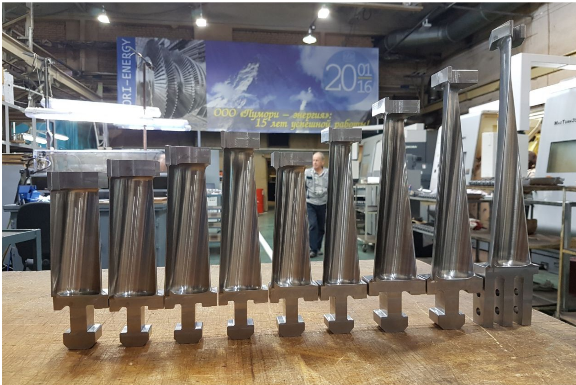
Рабочие лопатки 14-22 ст. паровой турбины Т-295-240 (УТЗ)
