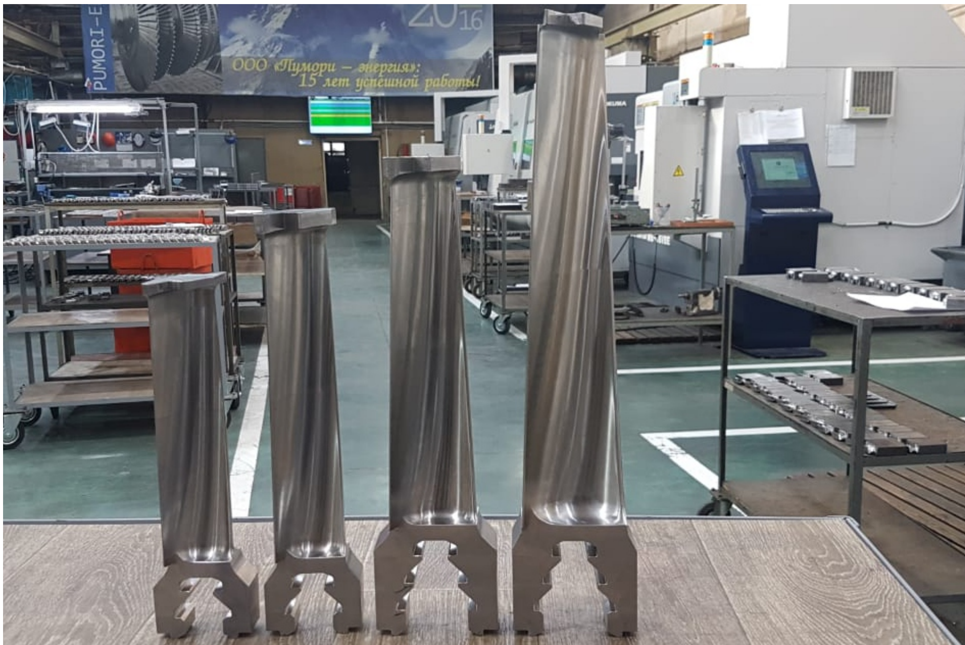
Рабочие лопатки 20, 21, 22 и 25 ст. турбины Тп-115 (УТЗ)
