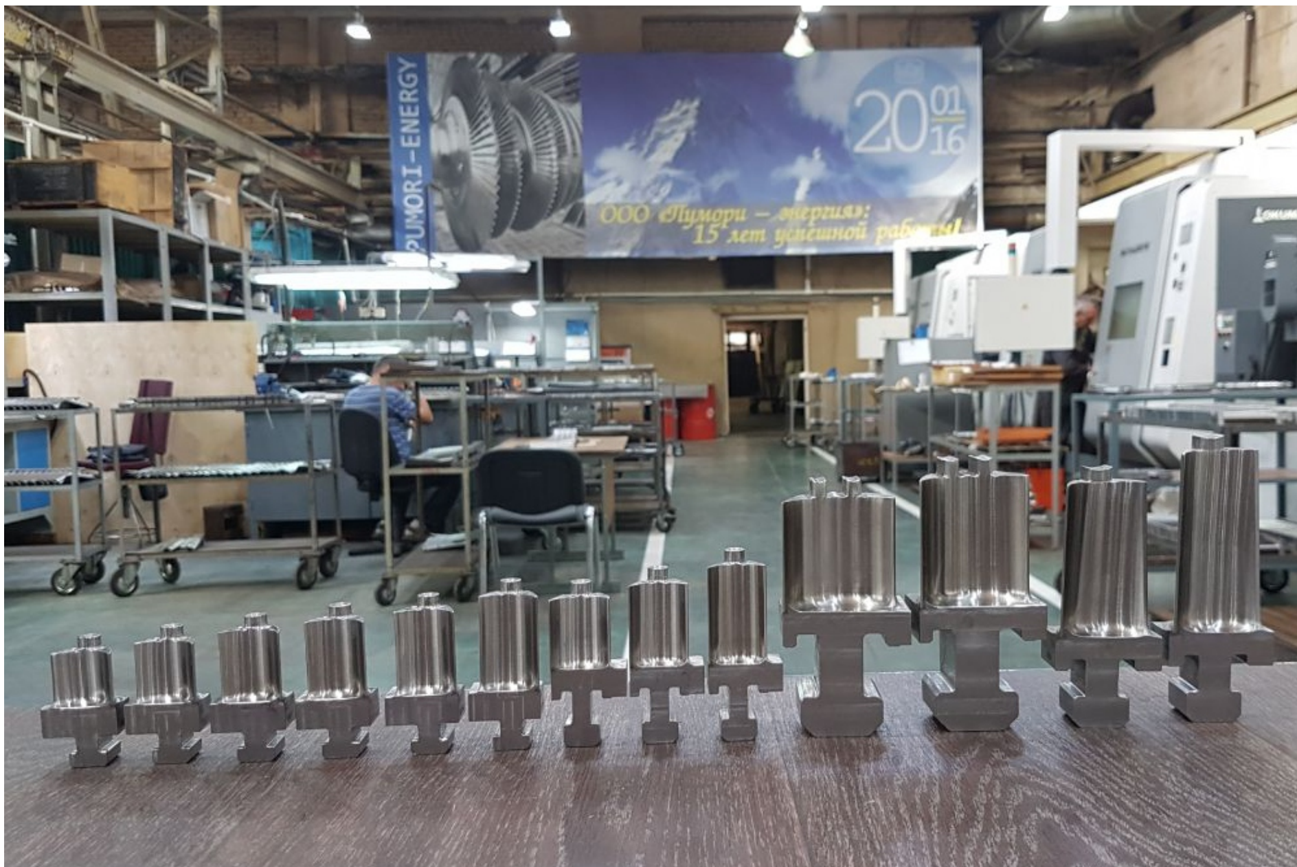
Рабочие лопатки 4-16 ст. паровой турбины К-65-12,8 (УТЗ)
