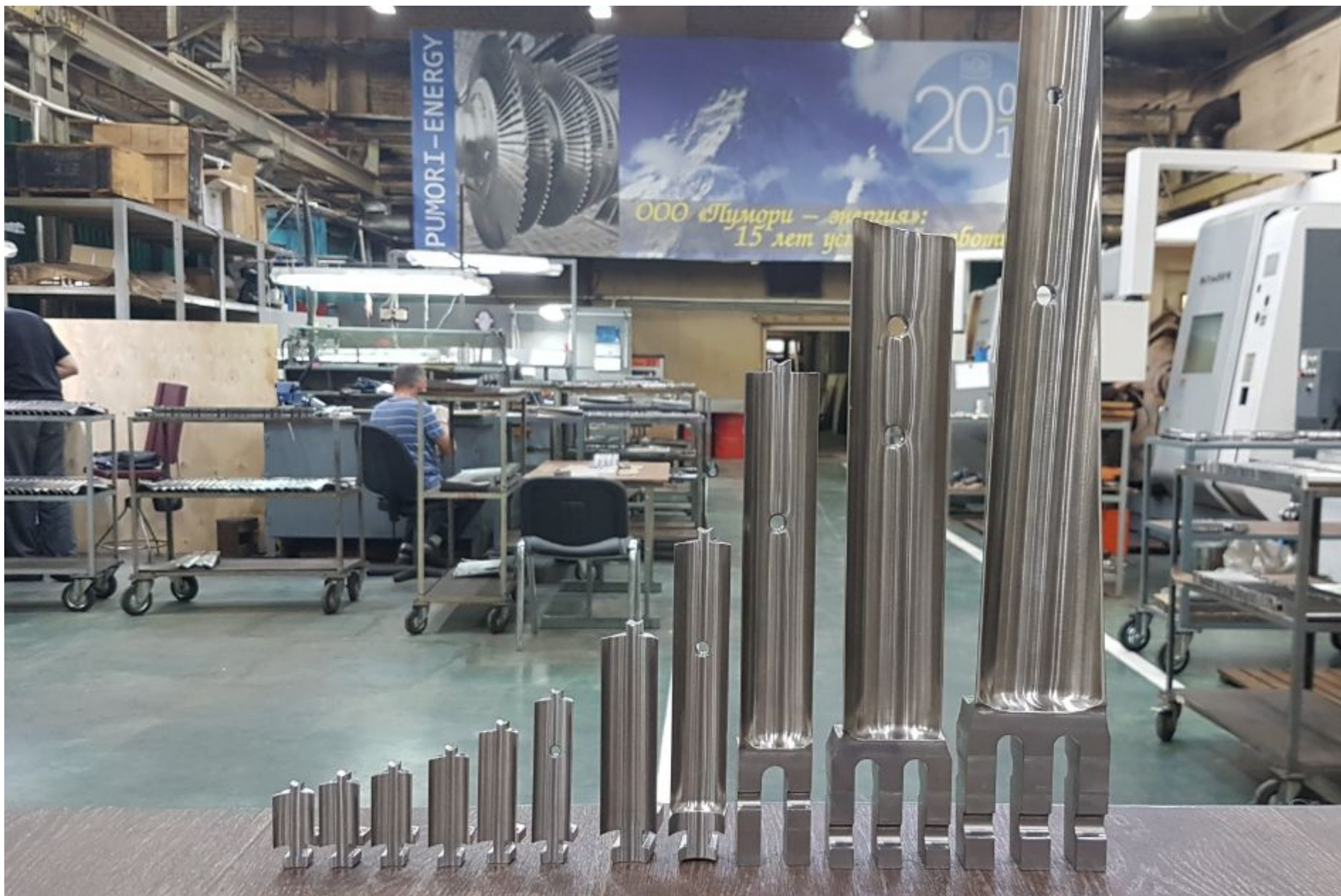
Рабочие лопатки 2-12 ст. паровой турбины К-15-41 (НЗЛ)
