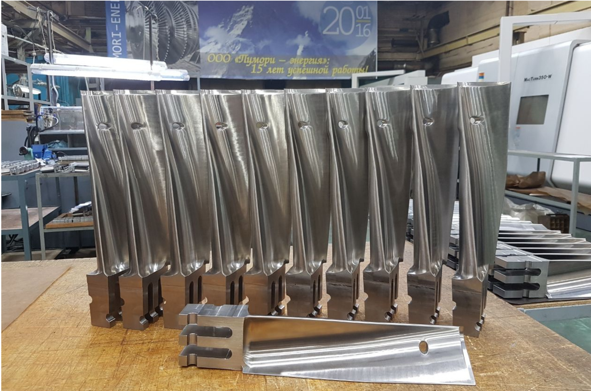
Рабочие лопатки 35 ст. паровой турбины Т-295-240 (УТЗ)
