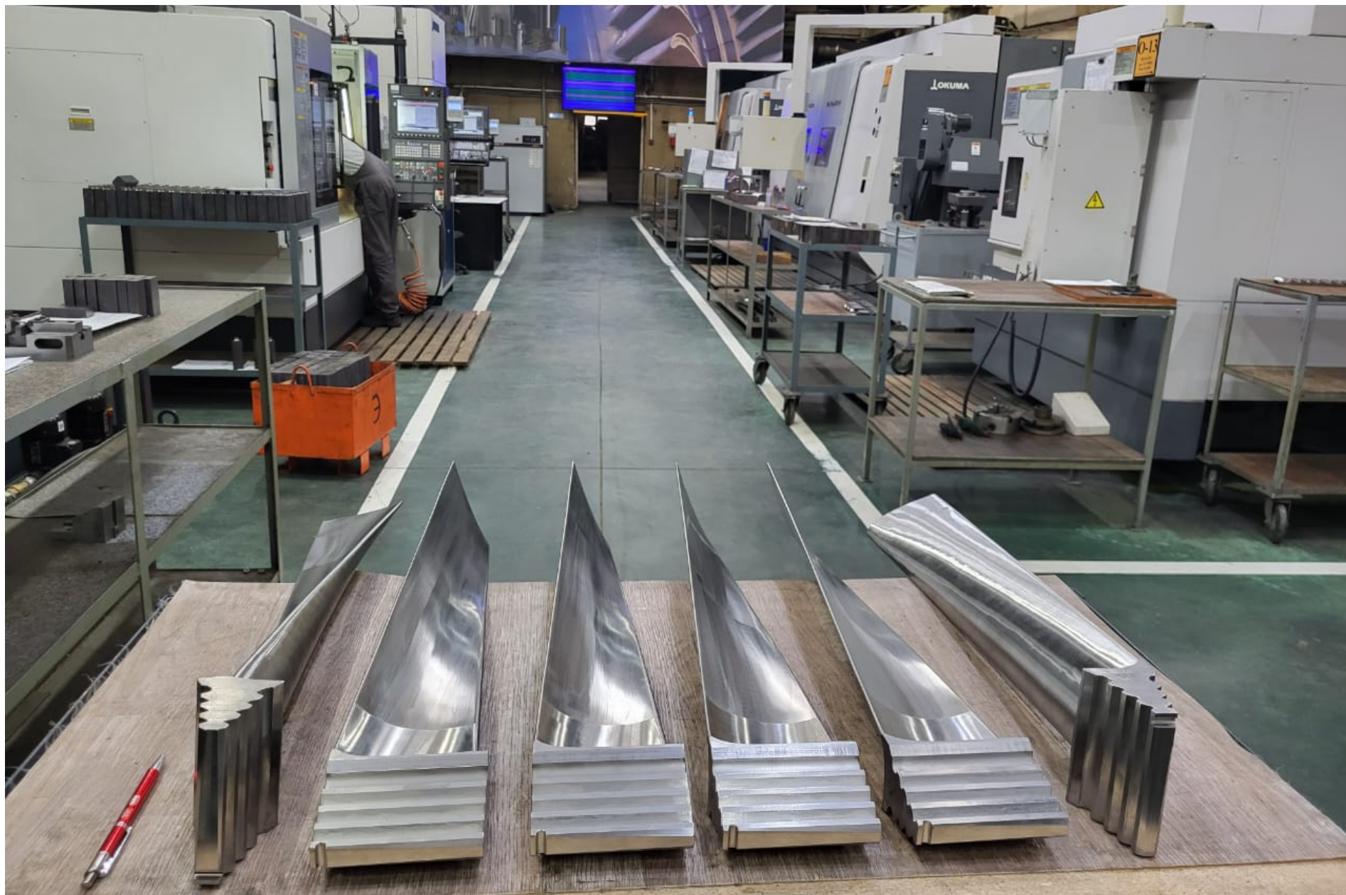
Рабочие лопатки 25 ст. паровой турбины Т-30 (дизайн «Сименс») Турбина изготовлена в Чехии, г. Брно Лопатки изготовлены с применением технологии реинжиниринга
