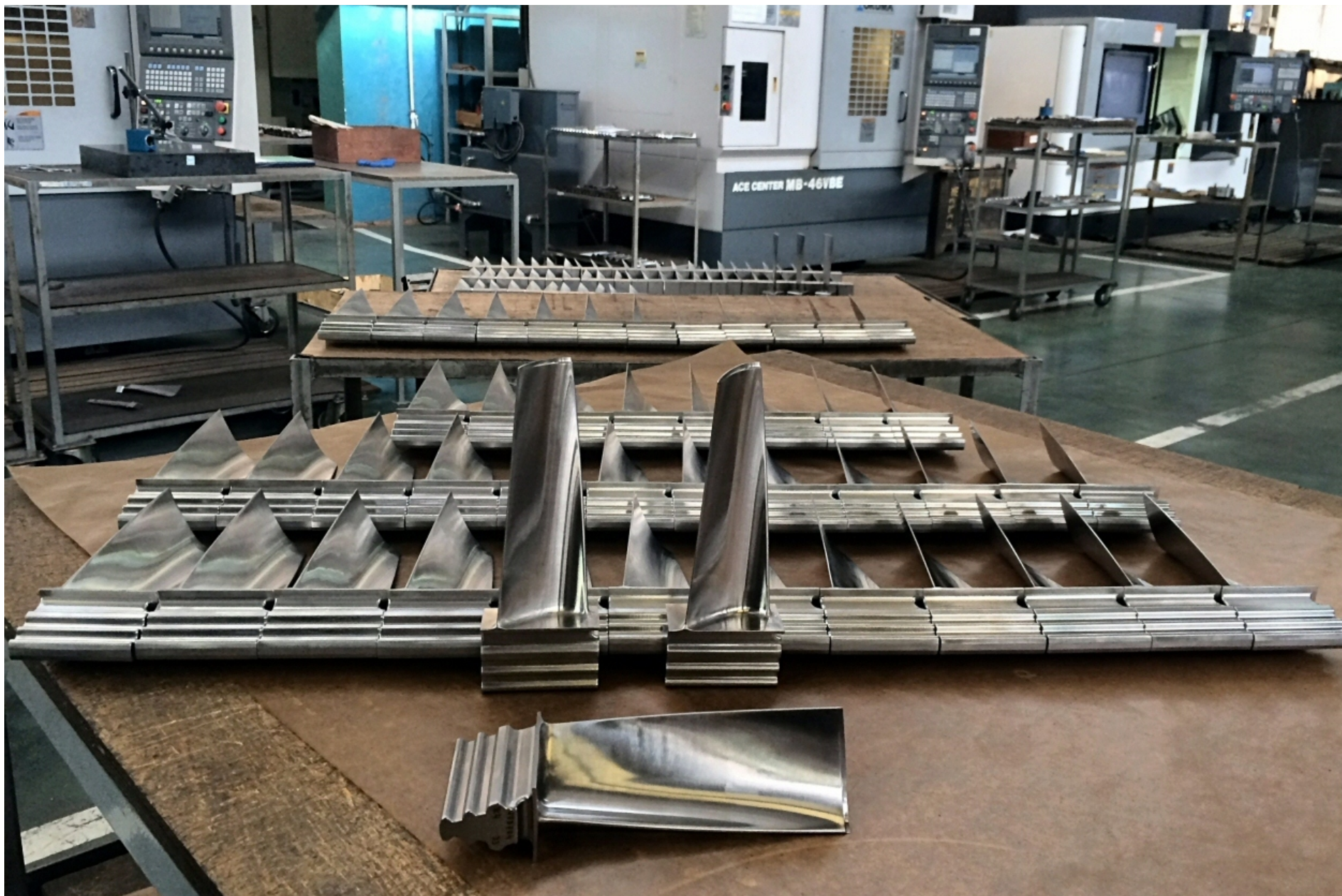
Рабочие лопатки 4 ст. Газовая турбина ГТН-6 (УТЗ)
