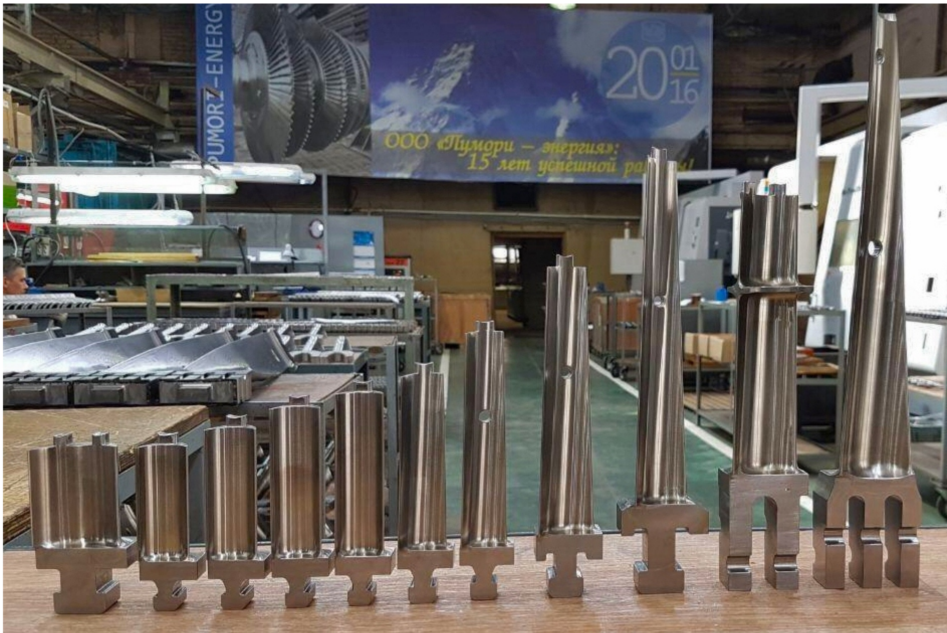
Рабочие лопатки 16-26 ст. турбины ПТ-60-90 (ЛМЗ)
