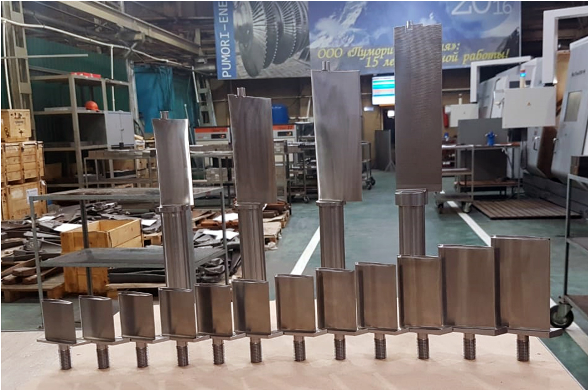
Направляющие лопатки 0-11 ст. и ВНА Газовая турбина ГТН-16 (УТЗ)
