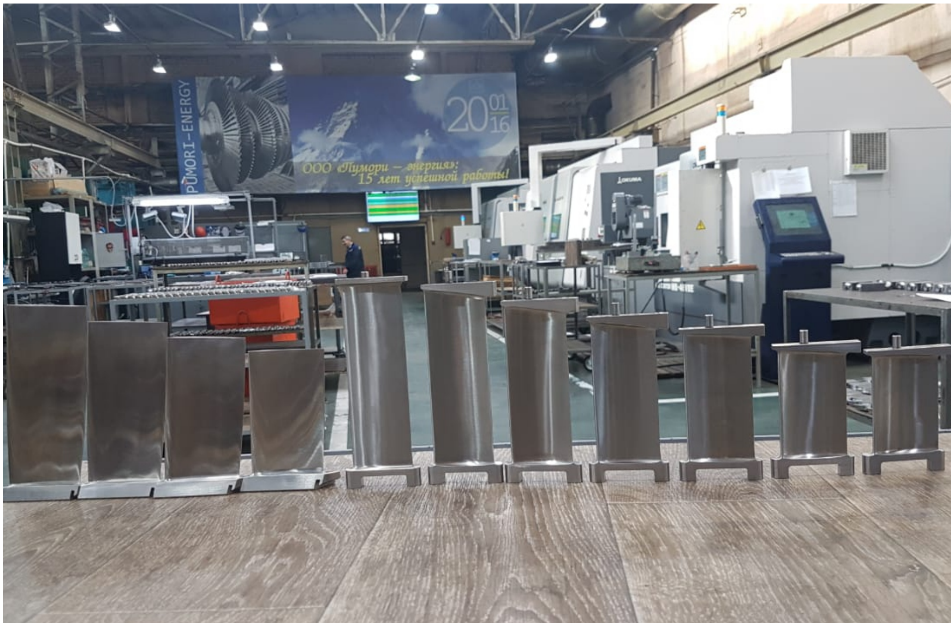
Рабочие и направляющие лопатки для судовой промышленности
