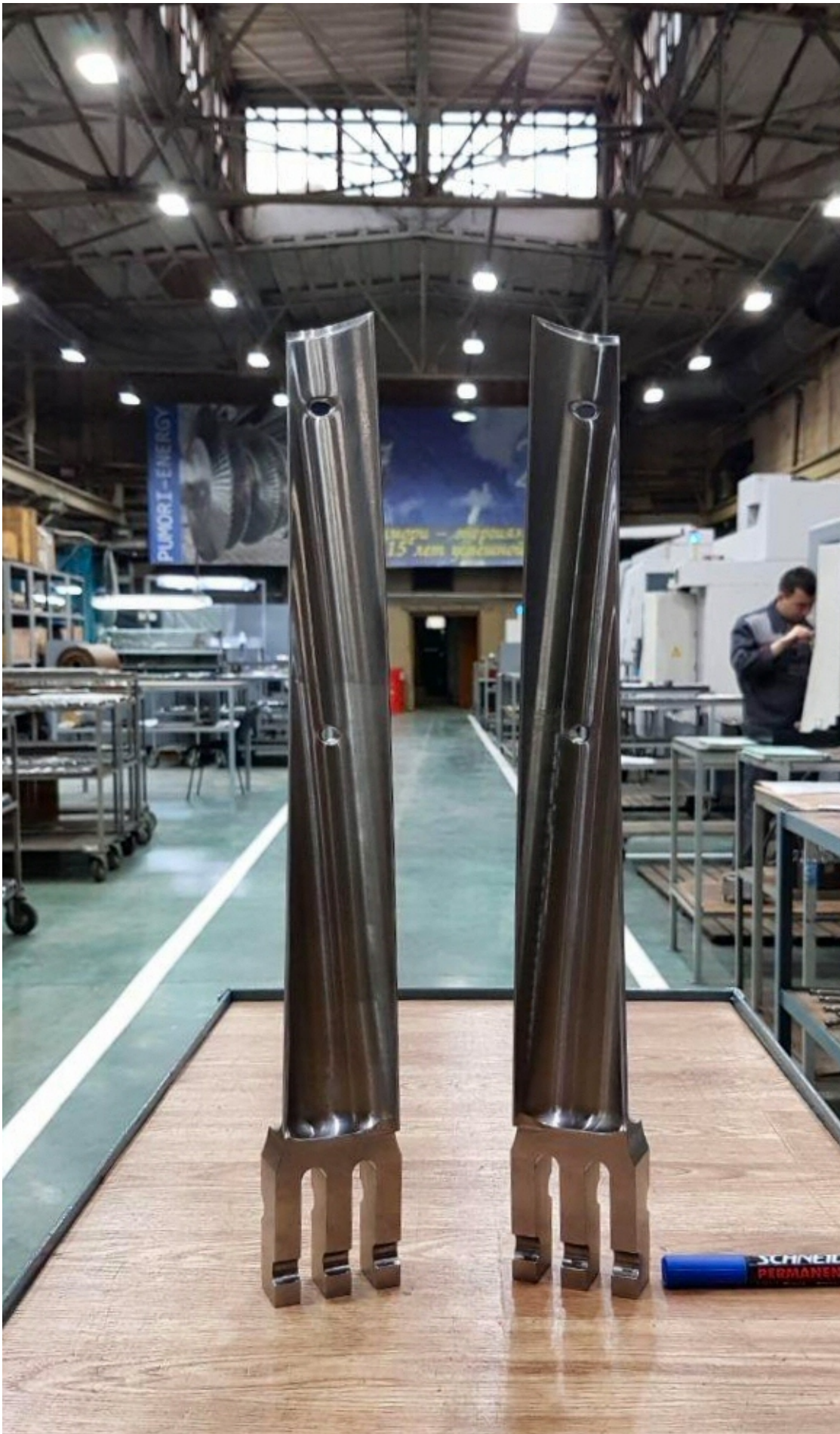
Рабочие лопатки 32 и 37 ст. турбины К-300-240 (ЛМЗ)
