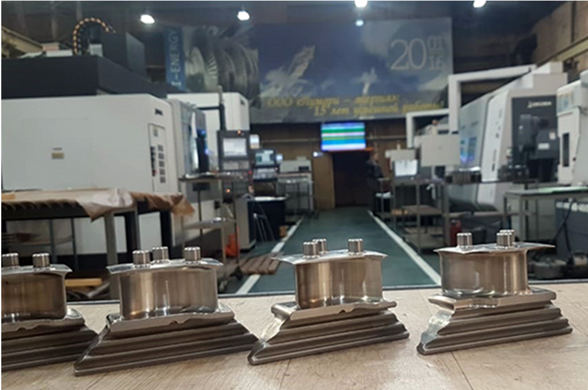
Рабочие лопатки турбины японской компании «Mitsubishi» (использована технология реинжиниринга)
