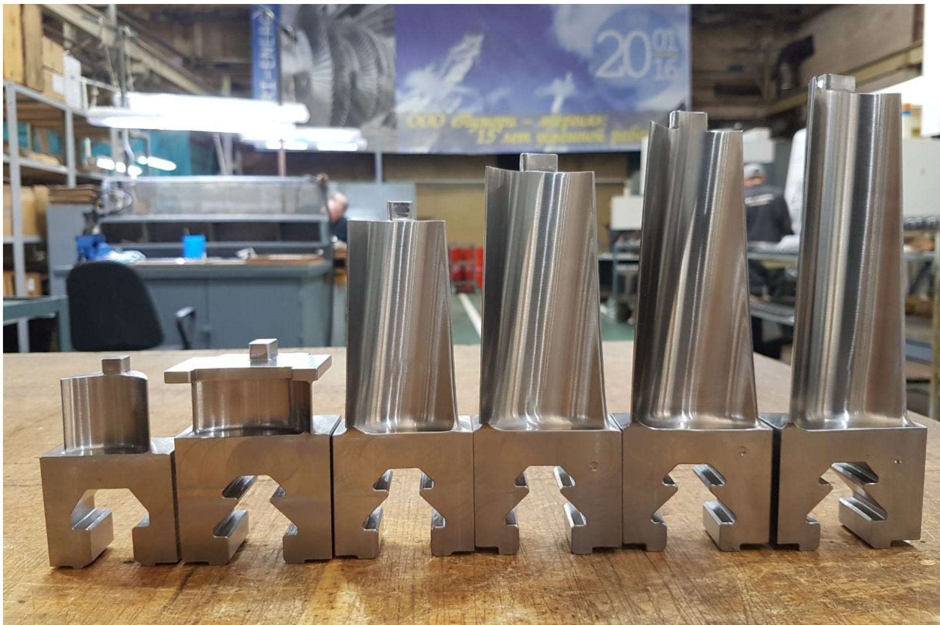
Рабочие лопатки 1-6 ст. паровой турбины К-300-240 (ХТГЗ)
