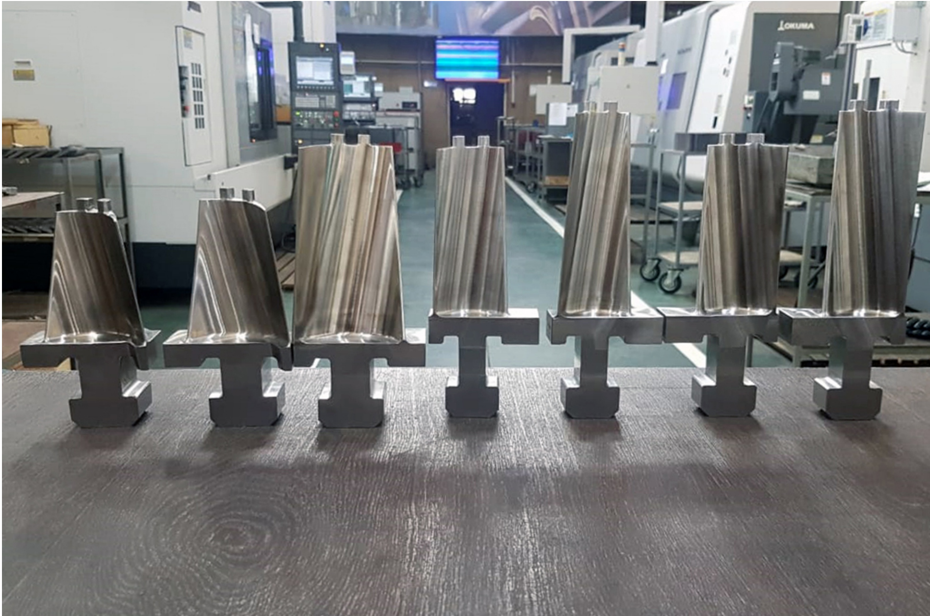
Рабочие лопатки 2, 3, 7 ст. РВД 14, 15, 23, 24 ст. РСД Паровая турбина К-800-240 (ЛМЗ)
