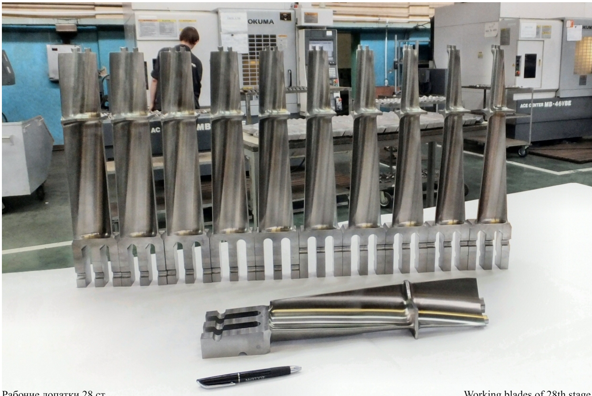
Рабочие лопатки 28 ст. Паровая турбина ПТ-80-130 (ЛМЗ)
