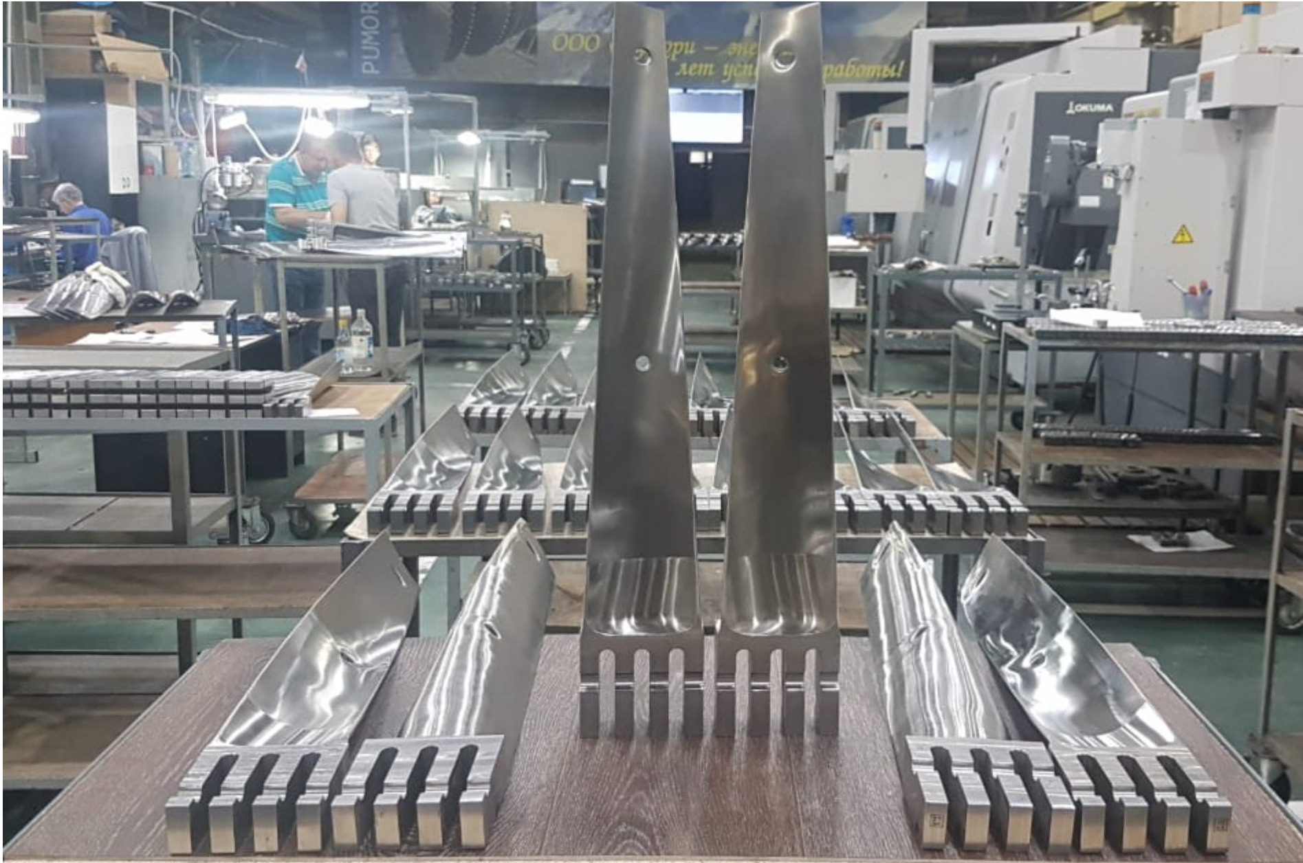
Рабочие лопатки 25 и 27 ст. турбины Т-100-130 (УТЗ)
