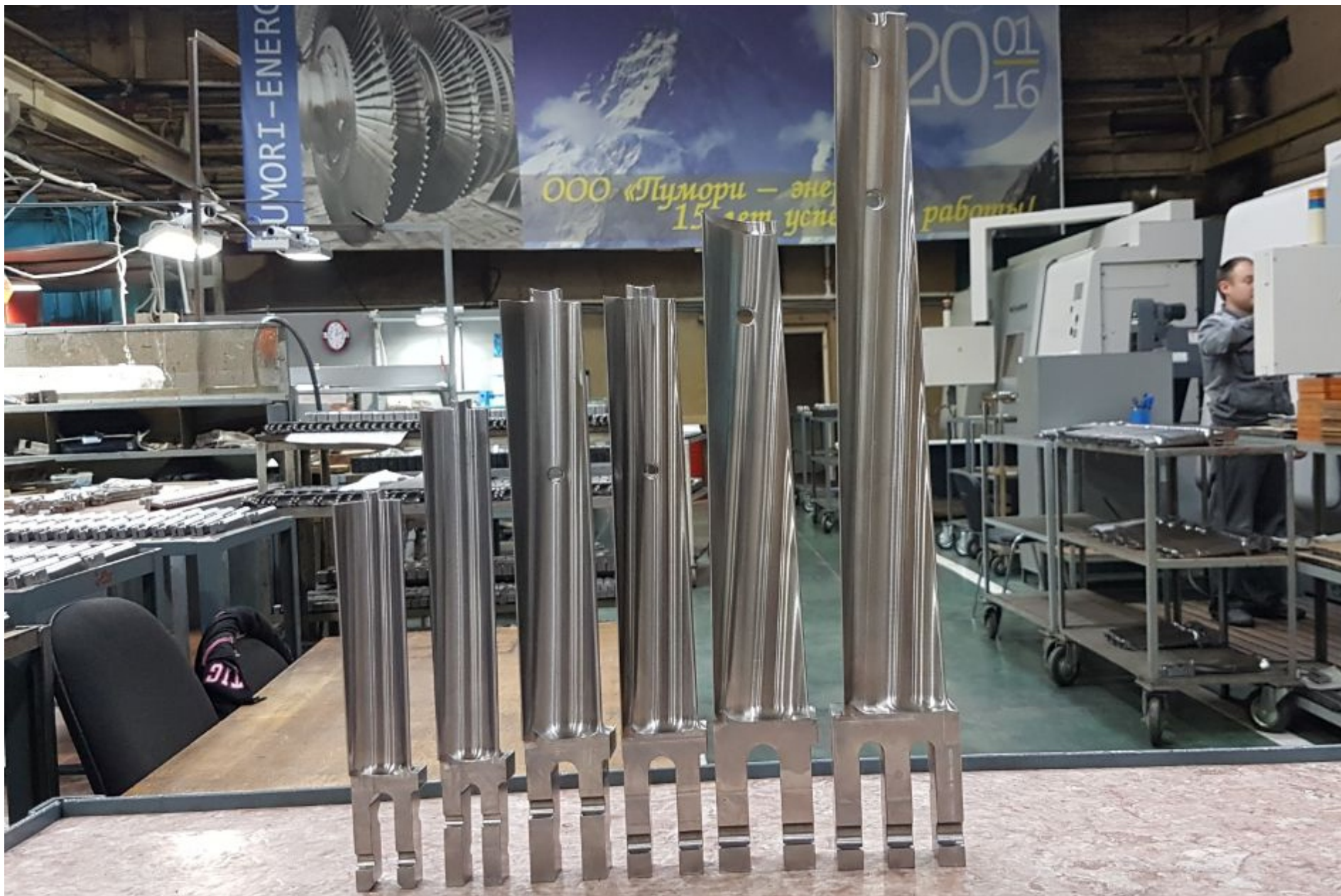
Рабочие лопатки 19-24 ст. паровой турбины Т-50-130 (УТЗ)
