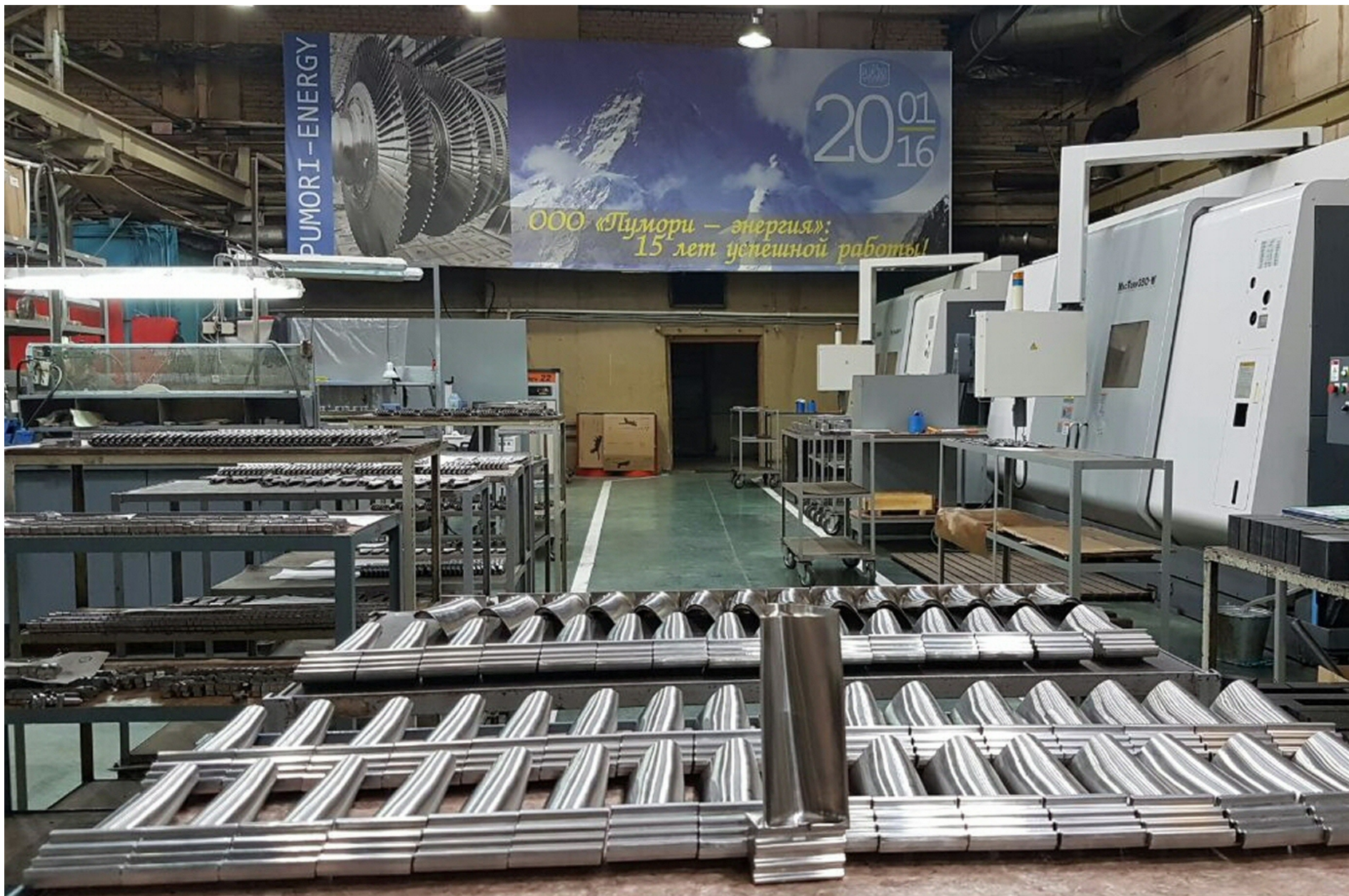
Рабочие лопатки 2 ст. газовой турбины ГТТ-12 (НЗЛ)
